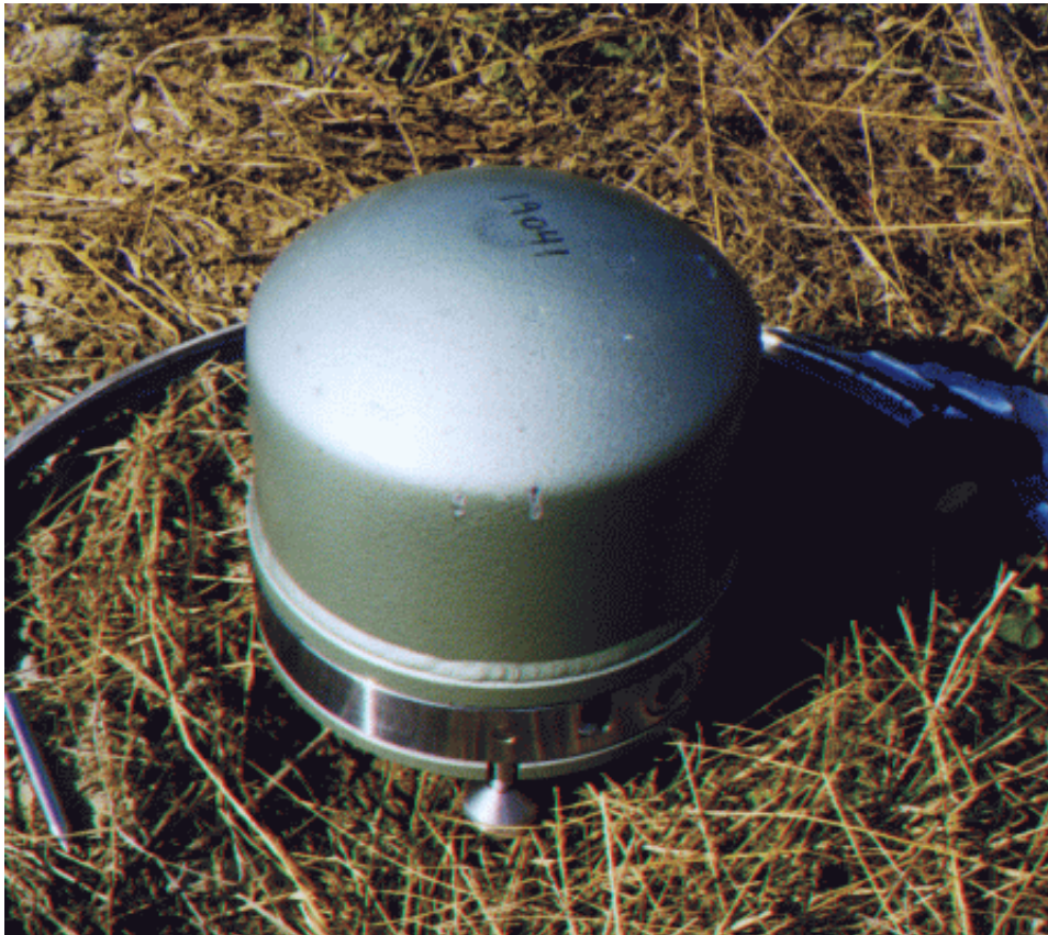
Fig 2. Wielandt-Streckeissen STS-2 seismometer
